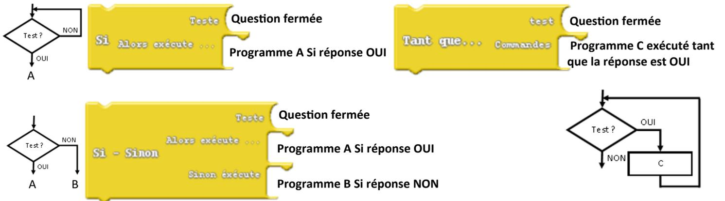
Blocs pour écrire les questions fermées d'un test.
